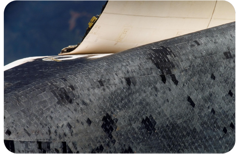
Uzay mekiğinin alt kısmında yer alan ve mekiği yüksek sıcaklıklardan koruyan yalıtkan tuğlalar. (Kaynak: Wikimedia Commons)
