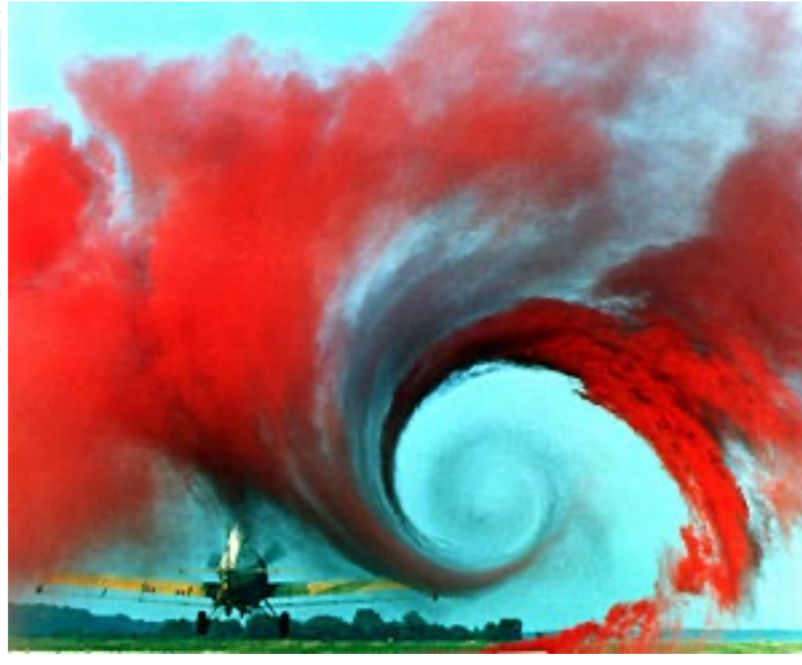
Kanat Uç Girdapları ve Rotor İz Bölgesi Akış Hesaplamaları
