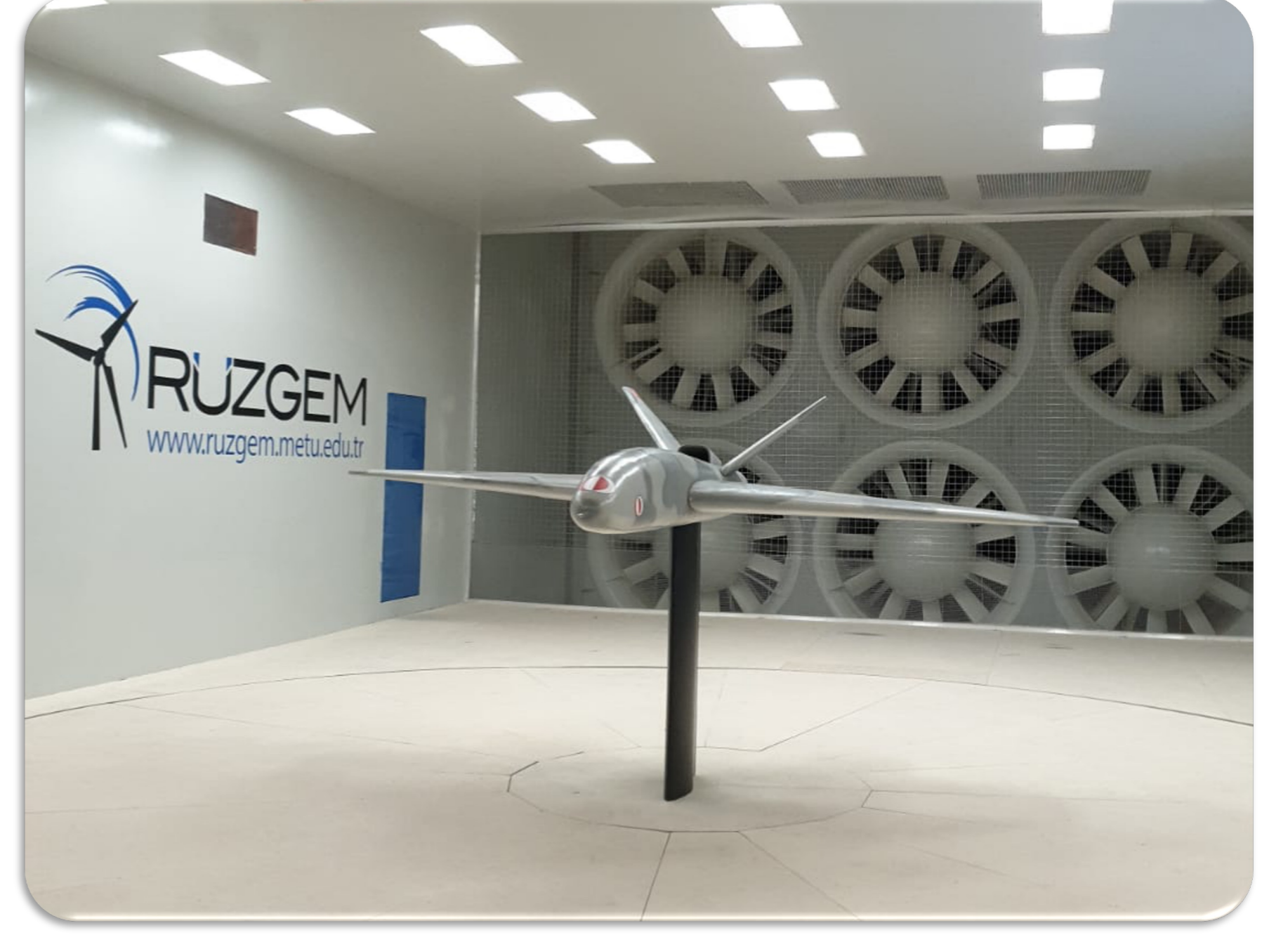
RÜZGEM Büyük Rüzgar Tüneli Aerodinamik Testler
