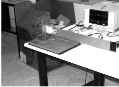
Şekil 2. Çalışmada kullanılan akıllı kiriş
