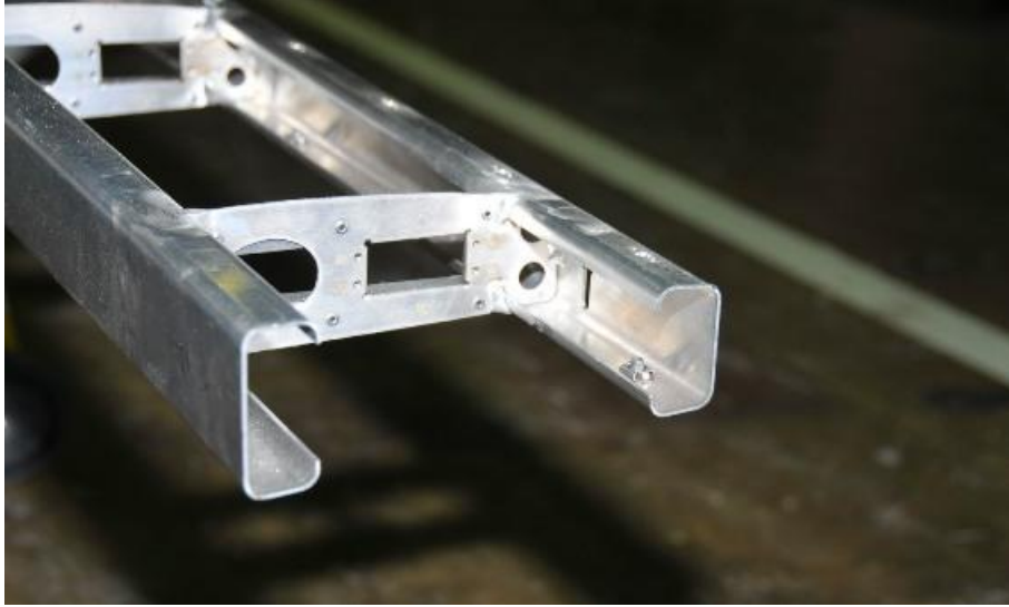
Şekil 13: Son Kanat Konfigurasyonunda Kaynaklama Yöntemiyle Birleştirilmiş Kiriş ve Sinirler
