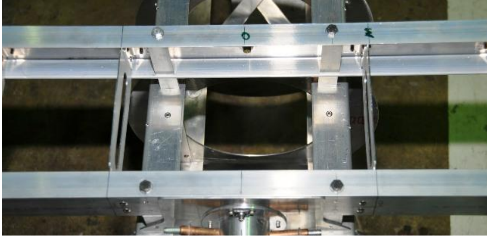
Şekil 4: İnsansız Hava Aracında Kullanılan Kanat-Gövde Bağlantısı
