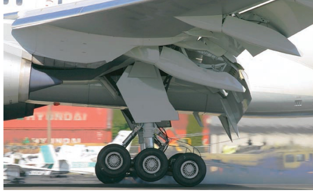
Şekil 2: Günümüz Uçaklarında Bulunan Karmaşık Kumanda Yüzeyleri ve Mekanizmaları
